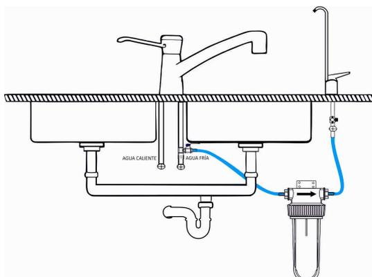
Ambos pueden funcionar bajo una presión de servicio de entre 2 y 10 vares.
